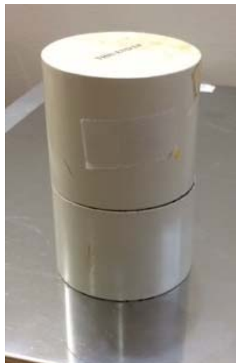
図 2. 表示付認証機器（校正用線源，Co-57）を保管していた鉛容器
