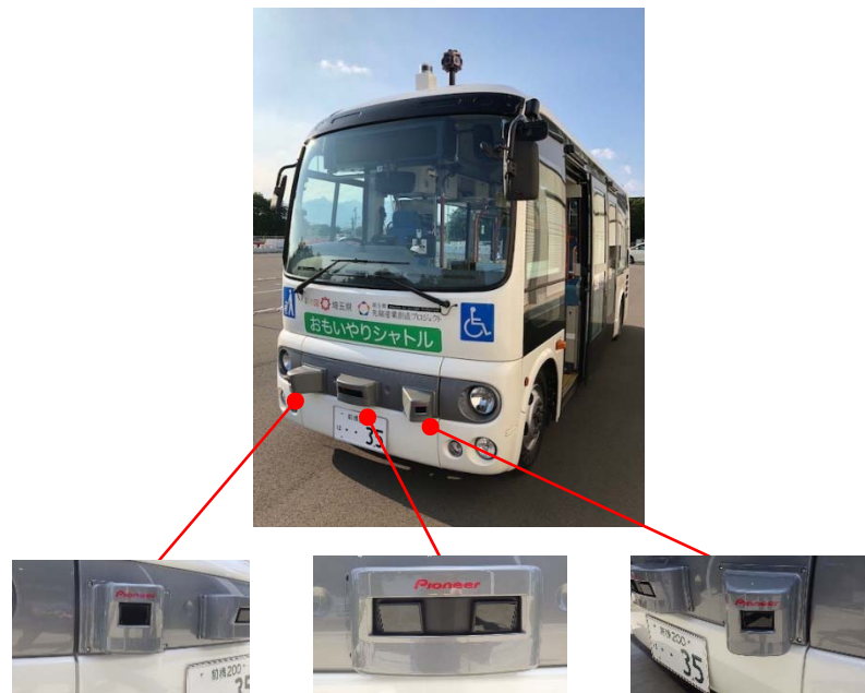
【群馬大学の自動運転バス車両に搭載されたパイオニア製 3D-LiDAR センサー】
